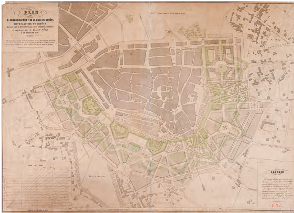
FIG. 31 1854 – Plan d’agrandissement de Genève, rive gauche. Signé par Léopold Blotnitzki, le plan adopté par le Conseil d’État reprend une série de tracés déjà proposés par Wolfsberger FIG. 30 . Entre la Corraterie et le futur boulevard Georges-Favon (sur la gauche du plan), un bastion est conservé comme lieu de promenade provisoire. En vert, le tracé des anciennes fortifications. BGE [VG 2894].
