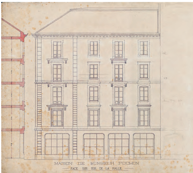
FIG. 37 Place des Eaux-Vives 8/rue Louis-Duchosal 6. Élévation de la façade sur rue par Émile Reverdin, architecte, 1880. Le règlement cantonal de 1854 génère des toitures d'immeuble dont les pans sont déterminés par un angle de 45 degrés. Cette forme de toiture perdue après les nouvelles possibilités offertes par le règlement de 1879. AEG [AP 194.A.50].
