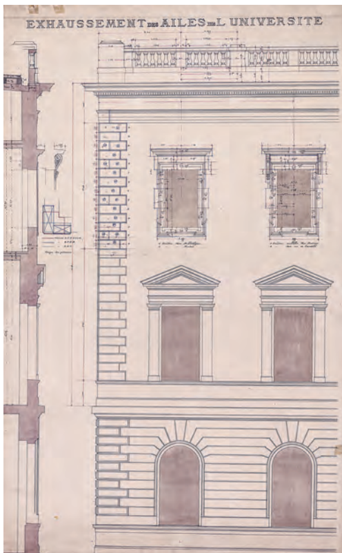
FIG. 228 Rue De-Candolle 5. Projet de surélévation des ailes de l'Université, 1898. L'architecte Léon Fulpius prolonge sur un mode mimétique la façade des années 1860. AEG [Travaux BB 17/447-57].
