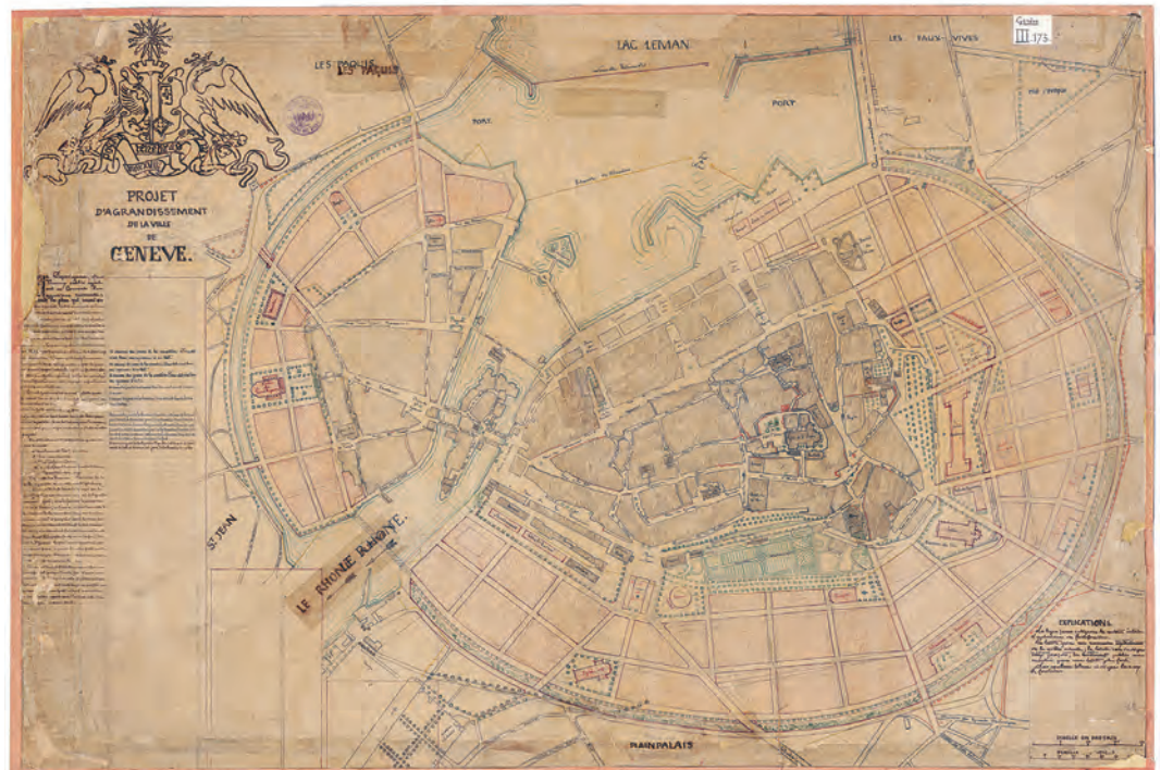
FIG. 23 1850 – Projet d’agrandissement de Genève, côté de Rive. Signé par l’inspecteur cantonal des travaux publics Jules Beaumont, ce plan articule deux géométries, l’une orthogonale, l’autre radiale, de part et d’autre d’une rangée de constructions formant le prolongement de la rue du Rhône. BGE [40g 03 18].
