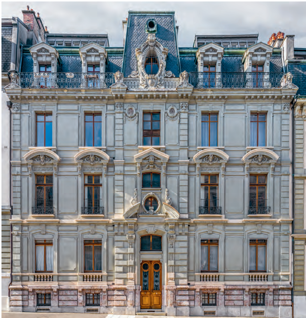
FIG. 405 Cours des Bastions 6. Des lucarnes architecturées et un œil-de-bœuf couronnent la façade sur rue de cet immeuble, conçu par les architectes Camoletti et Delesvaux en 1873. Ces éléments de toiture concourent à faire du bâtiment l'un des plus opulents de sa décennie. Photo Peter C. Taylor, 2024, IMAHGe.
